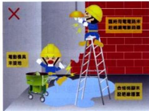
4. 停電作業之開關，應上鎖或標示「禁止送電」、「停電作業中」或設置監視人員監視之。調整電動機械而停電，開關應上鎖或掛警告牌非本人不得取下及送電。
