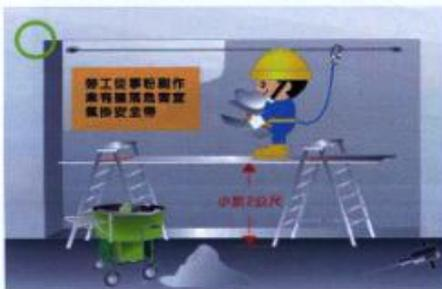
4. 作業高度超過 2 公尺之大面積油漆作業，應搭設施工架供勞工作業，並設置安全之上下設備。
