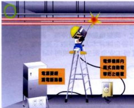
8. 電動機具之帶電部分，作業或通行有因接觸或接近時應設防止感電護圍或絕緣被覆。
