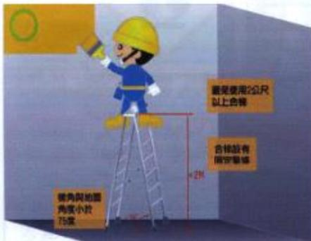
2. 作業高度超過 2 公尺應組搭(移動式)施工架或高空作業車，提供勞工油漆作業，避面使用合梯。
